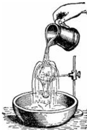
Рисунок 87. Закипание воды в колбе, обливаемой холодной водой.
