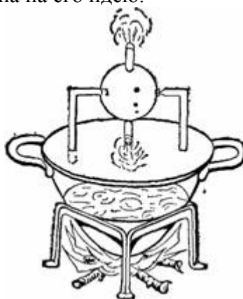
Рисунок 7. Самая древняя паровая машина (турбина), приписываемая Герону Александрийскому (II век до нашей эры).
