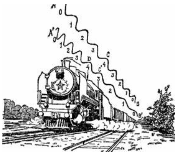
Рисунок 154. Задача о паровозных свистках. Вверху – звуковые волны, испускаемые неподвижным паровозом, внизу – движущимся.
