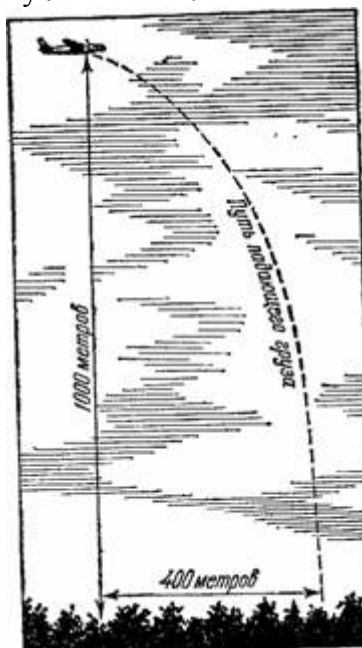
Рисунок 2. Груз, брошенный с летящего самолета, падает не отвесно, а по кривой.
