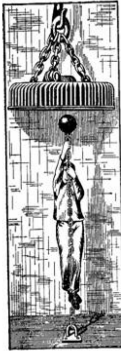
Рисунок 96. Железная цепь с грузом, торчащая вверх.
