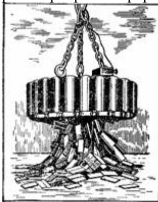
Рисунок 94. Электромагнитный подъемный кран, переносящий железные плитки.
