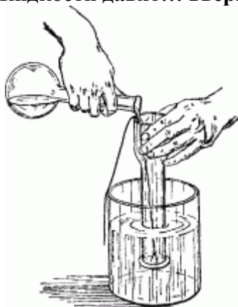
Рис. 53. Простой способ убедиться, что жидкость давит снизу вверх.
