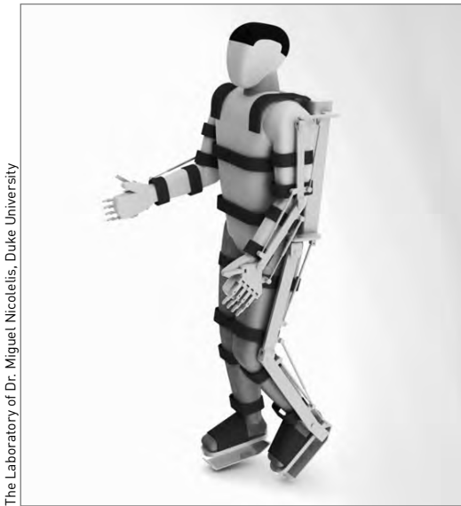
Рис. 10. Экзоскелет, которым, как надеется доктор Николелис, парализованный человек будет управлять мыслью
