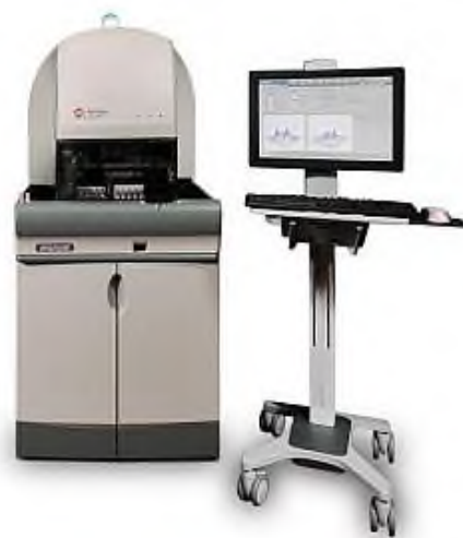
Рис.132. Гематологический анализатор UniCell DxH 800 (Beckman Coulter) использующий систему раннего обнаружения сепсиса.
