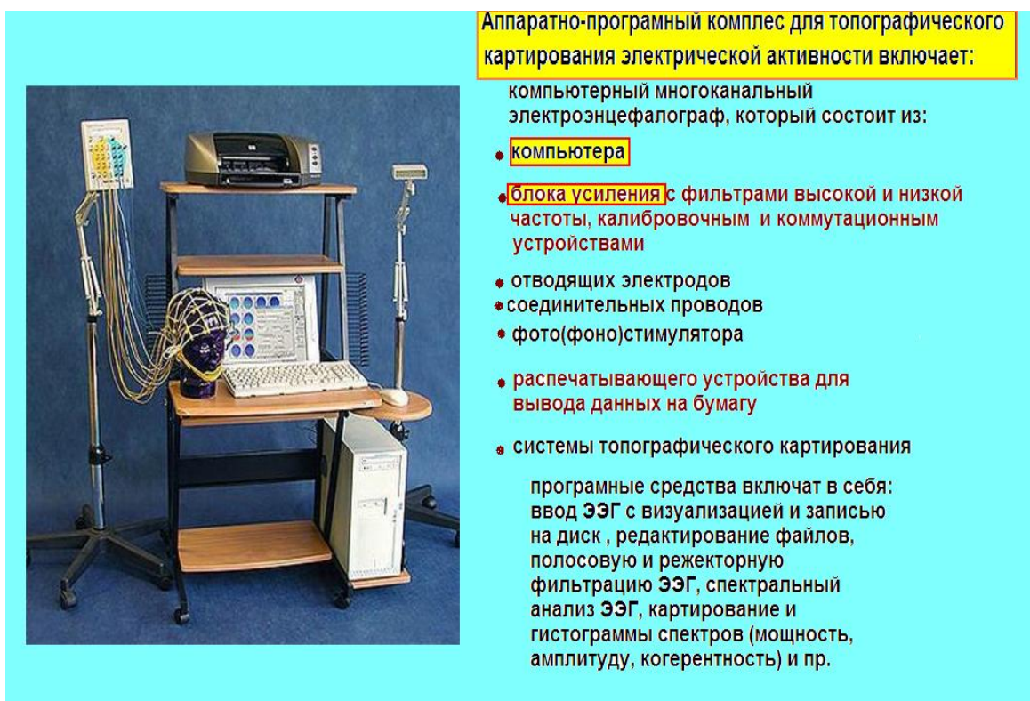
Рис. 1. Современный аппаратно-программный комплекс для регистрации и анализа ЭЭГ
