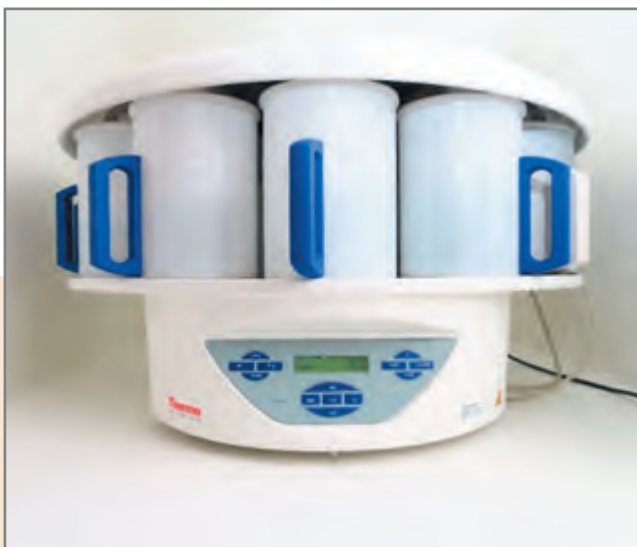
Рис. 2.5.6. Гистопроцессор, тип «Карусель», модель STP-120 «Микром» (Германия)
