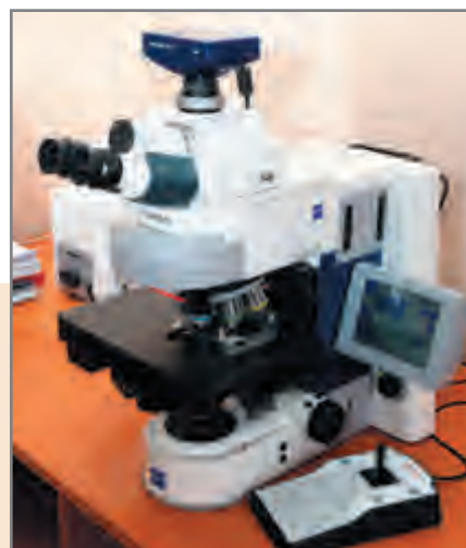
Рис. 2.5.11. Микроскоп для лабораторных исследований Axio Imager M2 ZEISS (Германия), укомплектованный цифровой камерой для ввода изображений
