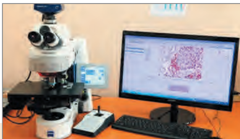
Рис. 2.5.21. Комплекс оборудования для морфометрических исследований, состоящий из микроскопа для лабораторных исследований Axio Imager M2, цифровой камеры, специальной программы ZEN 2012 для ввода изображений, проведения измерений, документирования, ZEISS (Германия) и компьютера
