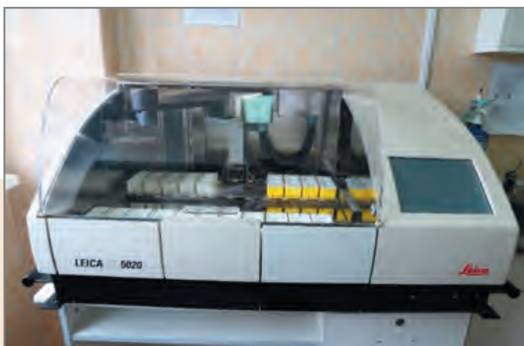
Рис. 2.5.10. Аппарат для окрашивания гистологических и цитологических препаратов ST 5020, LEICA (Германия)
