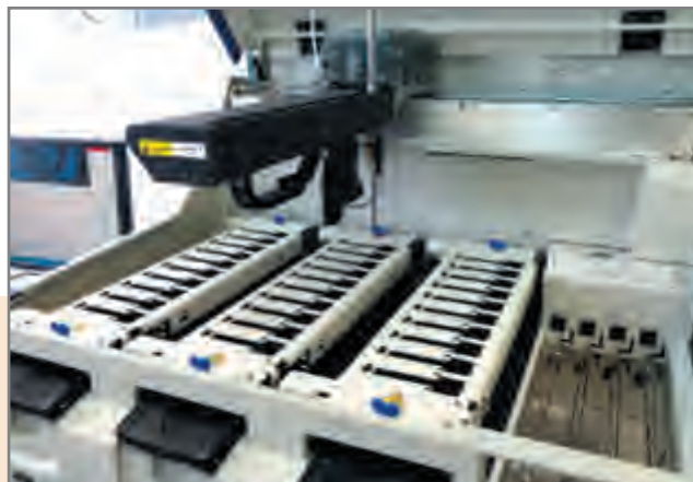
Рис. 2.5.13 Б. Рабочая камера иммуногистостейнера, состоящая из планшетов для стекол, блока для установки реагентов и манипулятора
