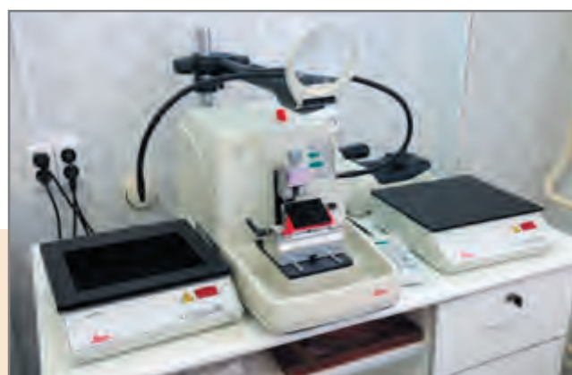
Рис. 2.5.8. Оборудование для изготовления гистологических срезов: полуавтоматический ротационный микротом RM2245, термованна для расправления и нагревательный столик для высушивания парафиновых срезов, LEICA (Германия)
