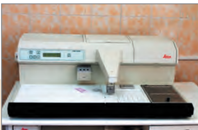
Рис. 2.5.7. Устройство для заливки образцов ткани парафином EG1160, LEICA (Германия)
