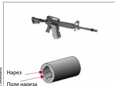
Рис. 3.9 Поперечное сечение ствола нарезного оружия: боевая винтовка М-16 калибра 5,56 x 45 мм. Видны нарезы и поля нарезов (выступающие участки между нарезами).
