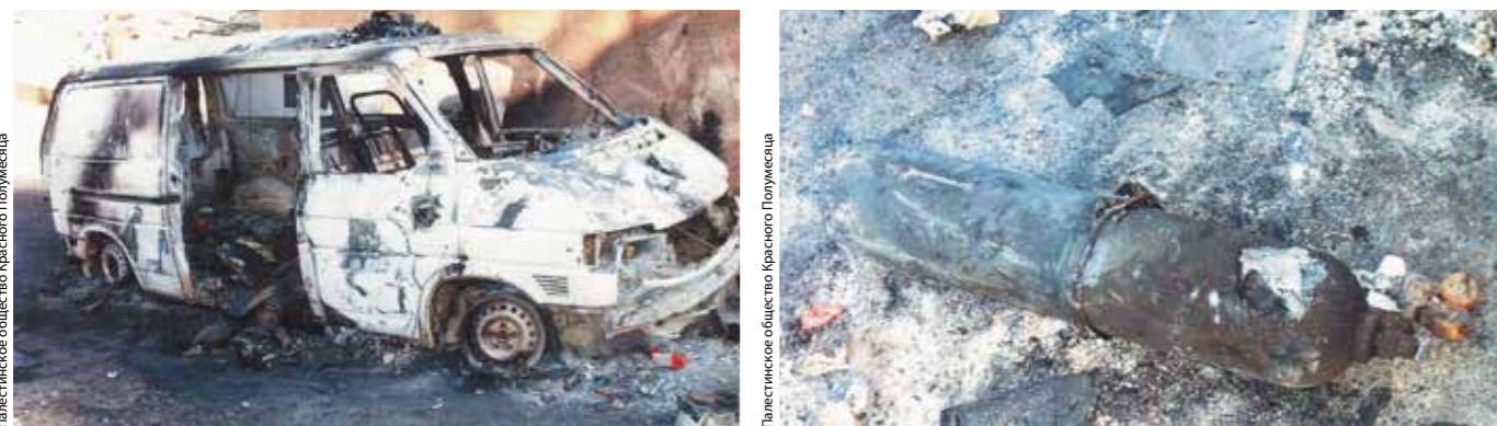
Рис. 7.4.1 и 7.4.2 Машина скорой помощи, уничтоженная взрывом кислородного баллона, который прошёл крышу машины как реактивный снаряд. На фотографиях мы видим машину и лежащий на земле баллон.
