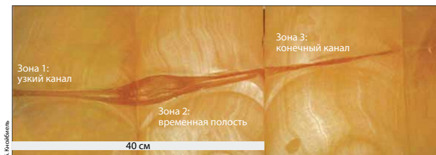
Рис. 3.13 Прохождение недеформируемой винтовочной пули в мыле.
