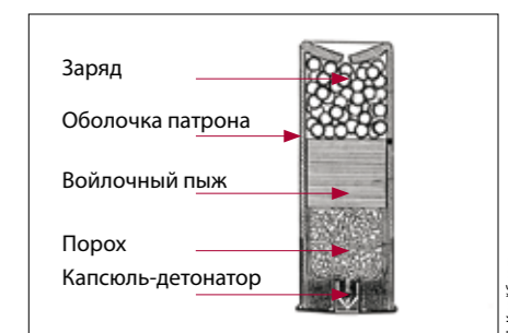
Рис. 3.8 Патрон дробового ружья и его заряд.
