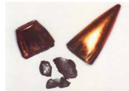
Рис. 3.17 Оболочка лопнула, выбросив наружу находившийся внутри неё свинец.
