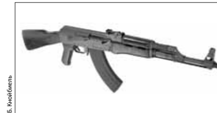
Рис. 3.2.4 Боевой автомат Калашникова АК-47 калибра 7,62 x 39 мм.
