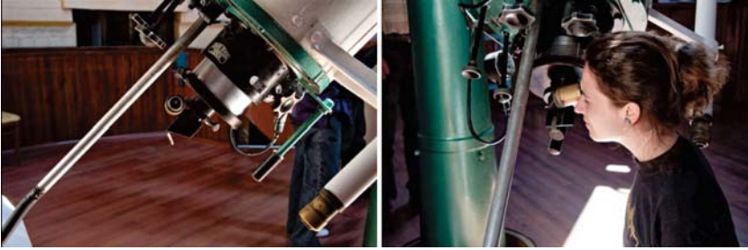
Рис. 10.3. Наблюдение Солнца на рефракторе с солнечным окуляром.
