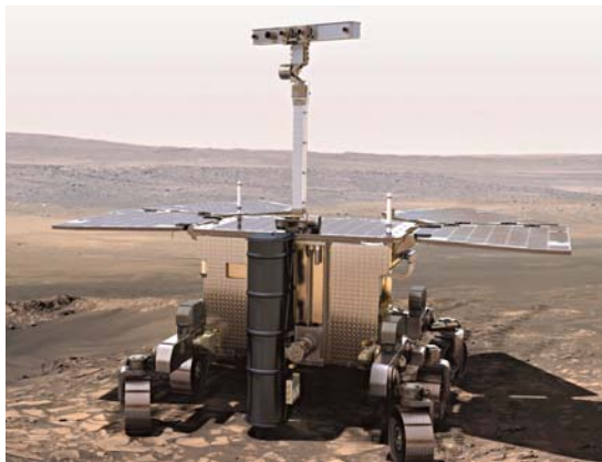
Рис. 5.32. Марсоход по проекту EхоMars (ESA/Роскосмос), предназначенный для биохимического исследования подповерхностного грунта.
