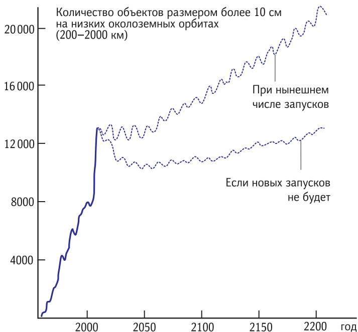
Рис. 9.16. Количество объектов размером более 10 см на околоземных орбитах высотой 200–2000 км по настоящее время и в будущем при реализации двух сценариев космической активности человечества.
