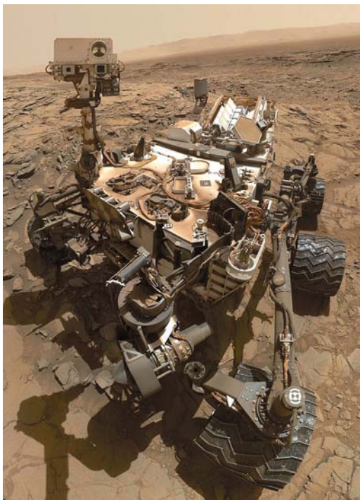
Рис. 5.22. Марсианский «внедорожник» Curiosity, работающий на ядерном топливе. «Автопортрет» аппарата, снятый его собственной камерой (штанга камеры не видна благодаря комбинации нескольких кадров).
