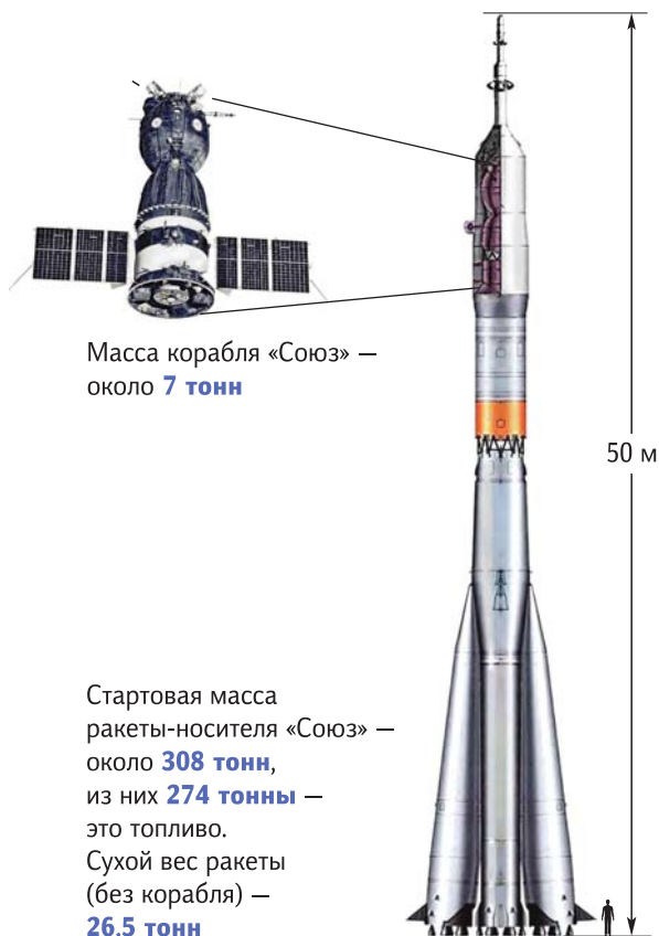
Рис. 2.17. Соотношение масс ракеты-носителя и ее полезной нагрузки. Ракета весом более 300 тонн создается только для того, чтобы маленький космический аппарат достиг устойчивой орбиты.
